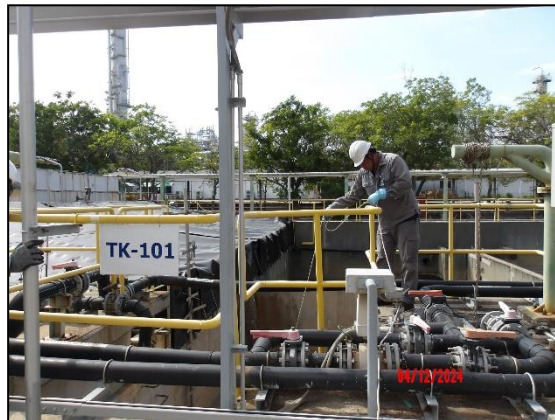
รูปที่ 4.6 การเก็บตัวอย่างคุณภาพน้ำ บริเวณบ่อปรับสมดุล (Equalization Sump) (TK 101)
