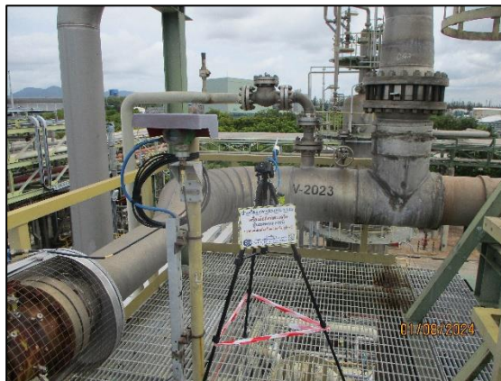
รูปที่ 4.9 การตรวจวัดปริมาณแอมโมเนีย บริเวณ Ammonia Vent Scrubber
