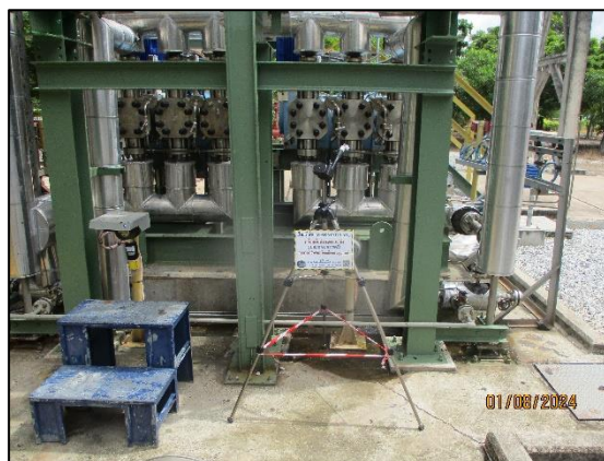
รูปที่ 4.10 การตรวจวัดปริมาณเอทิลีนออกไซด์ บริเวณพื้นที่กระบวนการผลิต
