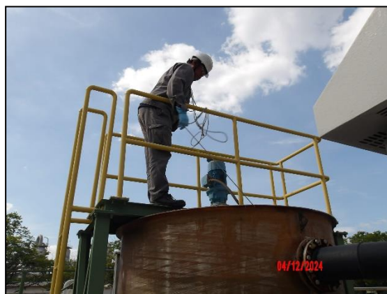
รูปที่ 4.7 การเก็บตัวอย่างคุณภาพน้ำ บริเวณจุดระบายออกจาก Neutralization Sump (TK 201)
